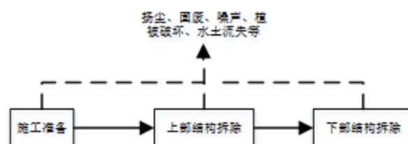
图 2-21 项目拆除工程施工工艺流程图
